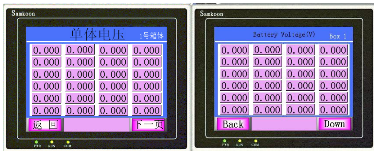
图 8-21 显示 4--单体电压/ Fig.8-21 Display 4--Battery Voltage
